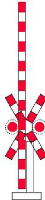
Trecere la nivel cu o cale ferată simplă cu semibarieră, prevăzută cu semnale luminoase de avertizare a apropiării trenului
