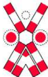
Trecere la nivel cu o cale ferată dublă, fără barieră, prevăzută cu semnale luminoase de avertizare a apropiării trenului
