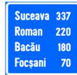
Confirmarea direcției de mers spre localități mai importante și distanțele până la acestea
