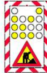
Semnalizarea unui utilaj care se deplasează lucrând
