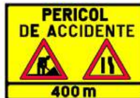
Presemnalizarea unui sector cu circulație alternantă
