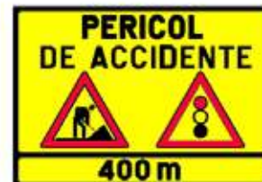
Presemnalizarea unui sector cu circulație alternantă
