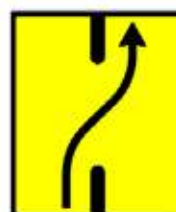
Terminarea abaterii temporare
