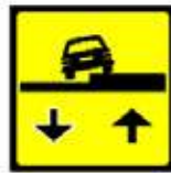
Denivelare față de banda alăturată
